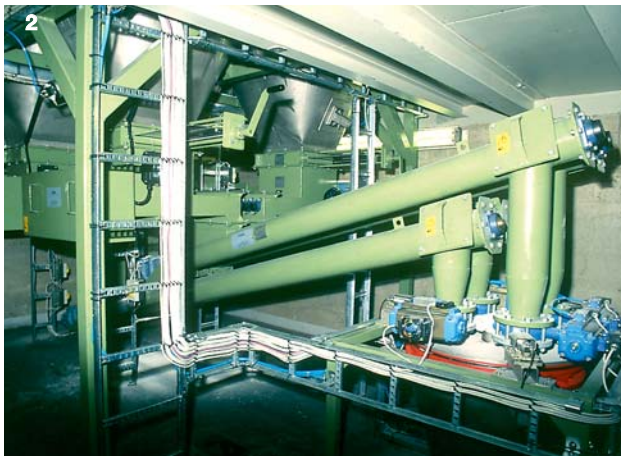
1 Dosieranlage für 3 verschiedene Flammschutz Chemikalien für Holzprodukte
